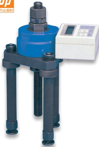
施工されたアンカーボルトが必要な性能を満たしているかどうか、引張荷重を掛けて確認する試験機です。荷重と変位を同時に測定できます。
