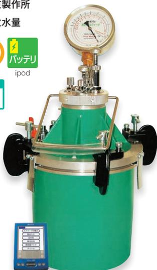
エアメータ法により生コンの単位水量を推定します。空気量測定と共にエアメータの質量情報等を追加することにより単位水量が推定できます。
