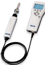
工業プロセスでの露点スポットチェック用としてお使いいただけます。 乾燥空気の低露点も測定可能で、データ収録容量は2700ポイント となります。※ご注文の際にプローブのご指示をお願いします。
