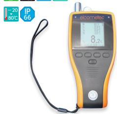
表面温度、気温、相対湿度をすばやく正確に測定できる携帯式の 計器です。読み取った値から、露点温度、表面温度と露点温度の 差、湿球温度、乾球温度、比湿を計算できます。
