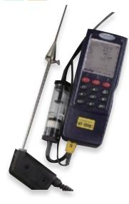
排ガス中の酸素、一酸化炭素、一酸化窒素など計測が可能なポータブルタイプ の燃焼排ガス分析計です。メモリ機能付で赤外線プリンタの使用が可能です。
