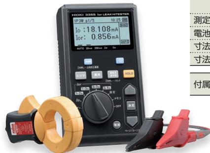
漏洩電流 (Io)・有効漏洩電流 (Ior)・対地絶縁抵抗値 (MΩ) が測定可能です。活線状態での絶縁点検が可能です。
