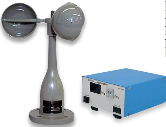
屋外での風の強さ(風速)を測定できます。瞬間風速、平均風速(10分)をスイッチの切替だけで表示し、設定された警報値に達するとブザーを鳴らすこともできます。
