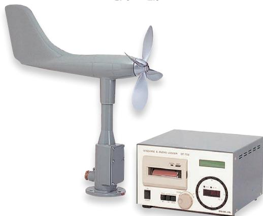
警報、印字機能付の風向風速計です。瞬間値または平均値をデジタル表示すると同時に内蔵メモリに保存、プリントアウト、警報設定ができます。設定値以上になると警報ブザーを作動します。印字内容は設定時間毎の方位、最大値、平均値その日の最大風速とその時の方位などです。
