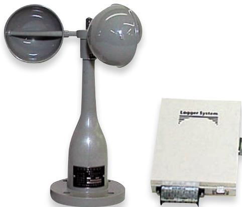
電源に乾電池を用い、長時間風速データを収録できます。瞬間・平均風速を10分毎に記録し、CFカードを介しパソコンにデータを転送し、日報・月報の作成ができます。
