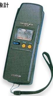
風速測定機能は、瞬間・最大・最小・平均の4種類です。加えて温度測定機能も付いています。
