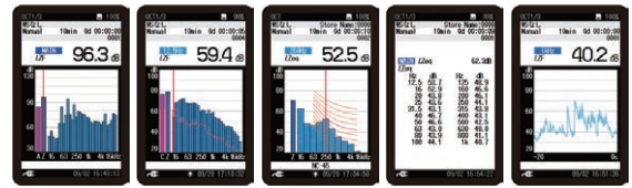
1/3オクターブ分析器画面 重ね合わせ分析画面 NC曲線画面 数値リスト表示画面 測定画面 (T-グラフ表示)
