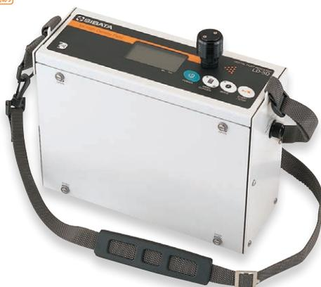
測定範囲が100.0mg/m<sup>3</sup>までの高濃度タイプです。ずい道建設工事など比較的高濃度な粉じん作業場での測定を可能にします。※正しい測定を行うためには、適切なK値の測定が必要です。
