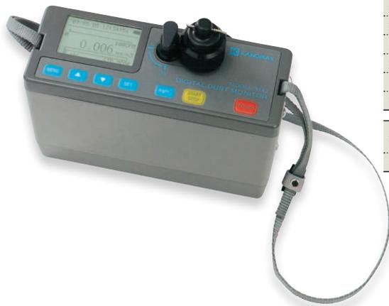
室内、工事現場内などにおける浮遊粉じん量を測定できます。空気中の浮遊粒子に光を照射すると、粒子から散乱光が生じます。この散乱光の強さを粉じん濃度に変換し、カウント値として積算しています。
