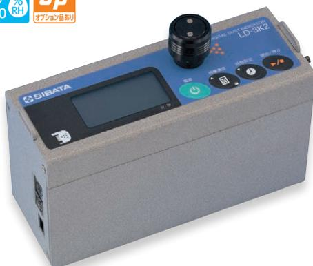
室内、工事現場内などにおける浮遊粉じん量を測定できます。空気中の浮遊粒子に光を照射すると、粒子から散乱光が生じます。この散乱光の強さを粉じん濃度に変換し、カウント値として積算しています。
