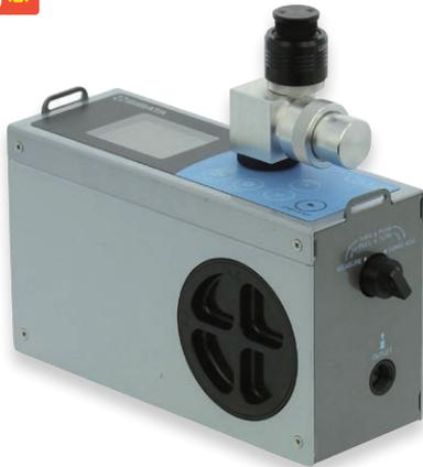
「ずい道等建設工事における粉じん対策に関するガイドライン\*」に新設された、「空気中の粉じん濃度等の測定」に対応した分粒装置付きのデジタル粉じん計です。
