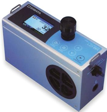
作業環境、ずい道工事などに係る浮遊粒子状物質の測定ができます。空気中の浮遊粒子に光を照射すると、粒子から散乱光が生じます。この散乱光の強さを粉じん濃度に変換し、カウント値として積算します。※正しい測定を行うためには、適切なK値の測定が必要です。
